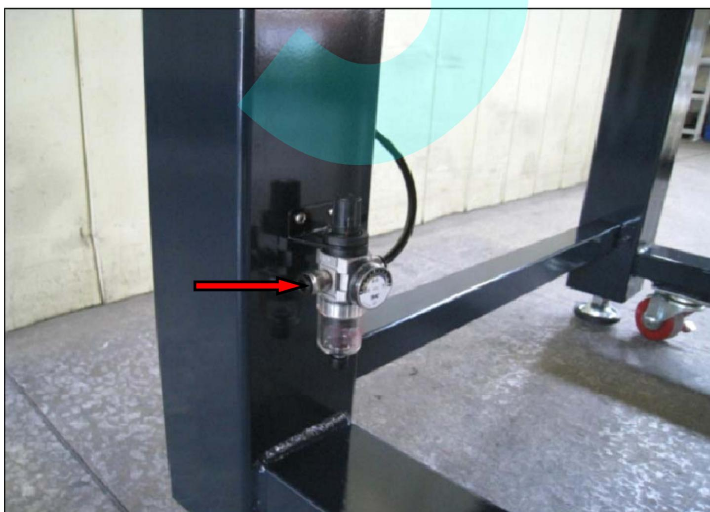
圖3) 將PU管如圖，完成空壓管配線。
