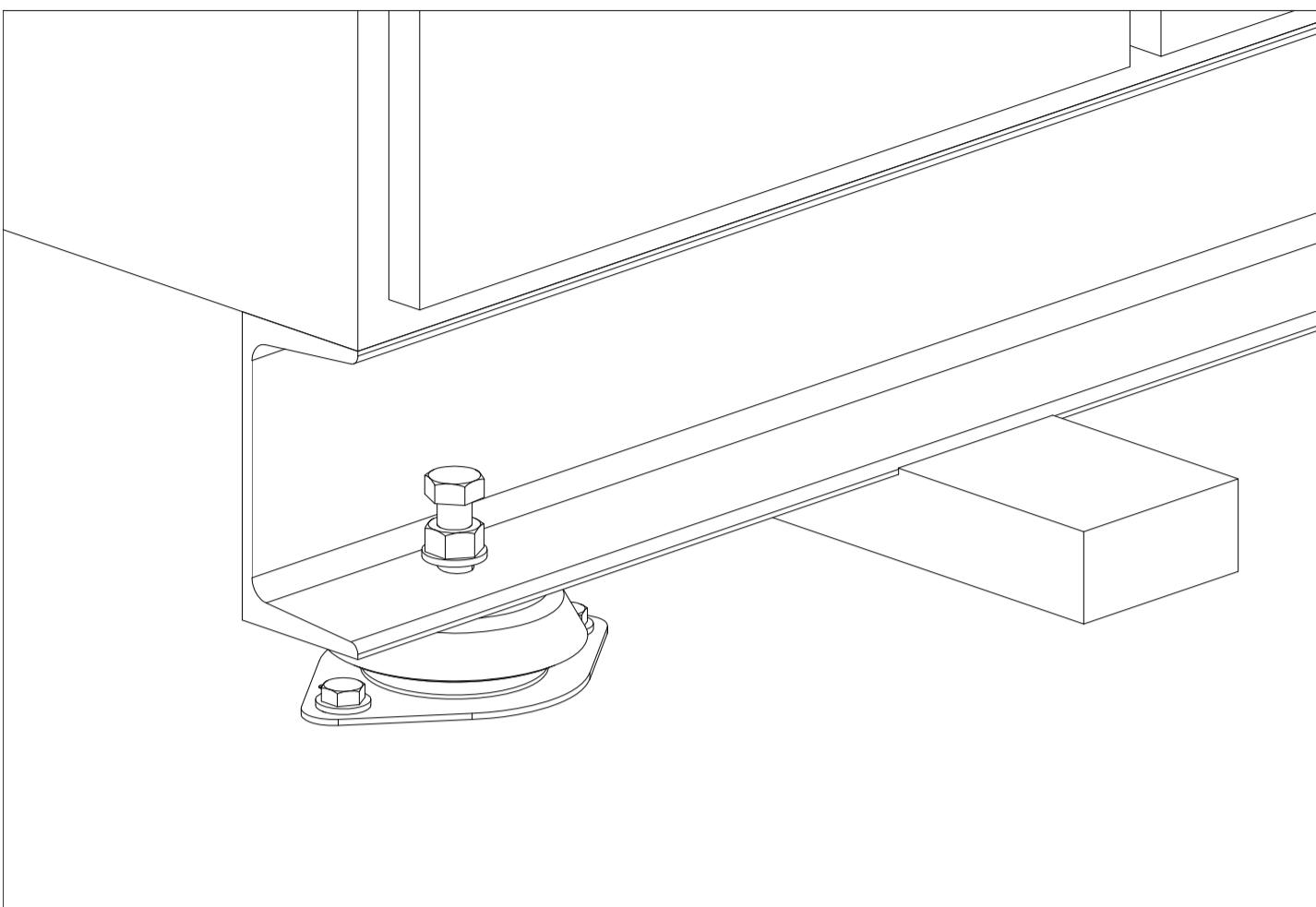
圖4)並以M12-基礎螺栓將避震器固定於基礎
