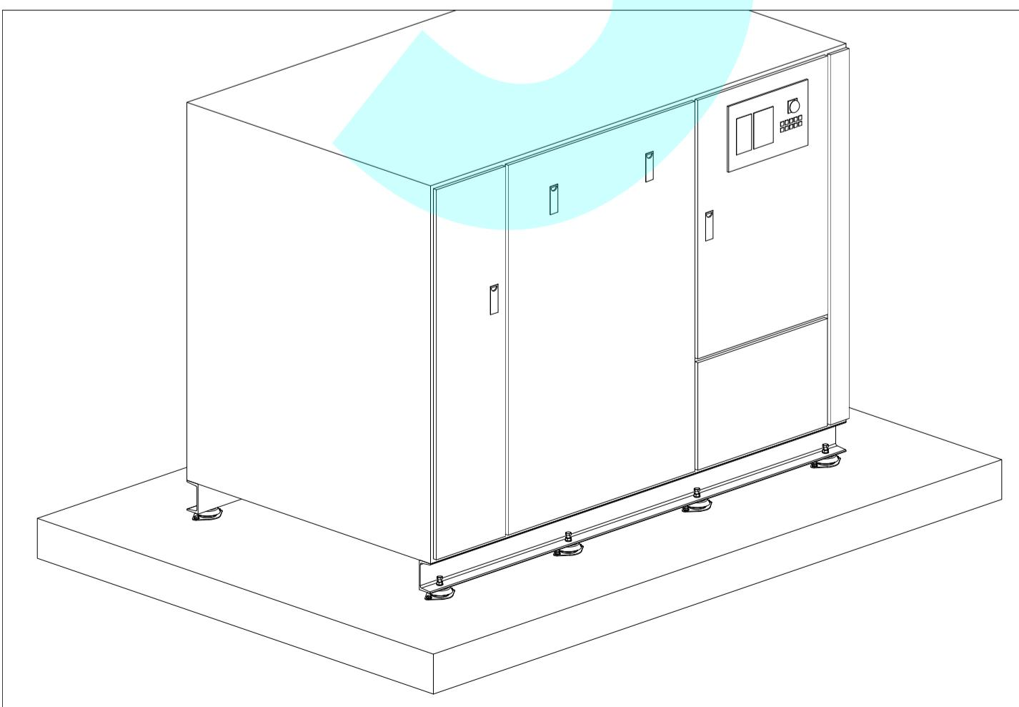
圖6)將M16固定螺栓確實與設備鎖緊，即完成避震器之安裝。
