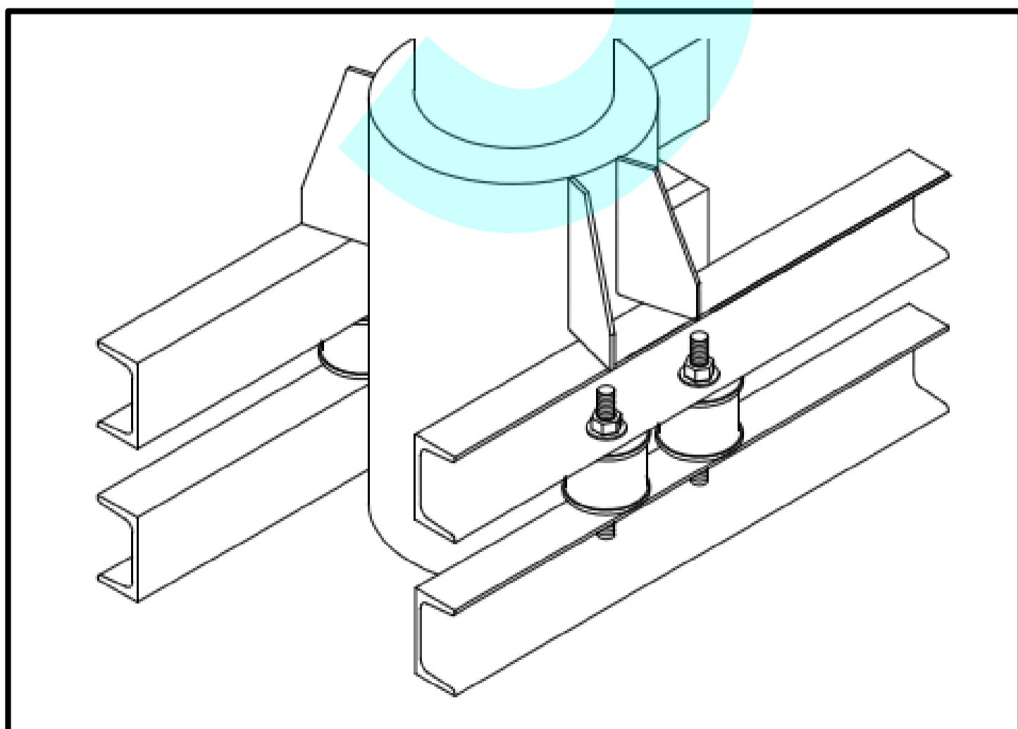
圖3)鎖緊螺母和墊圈，確保設備和避震器固定。
