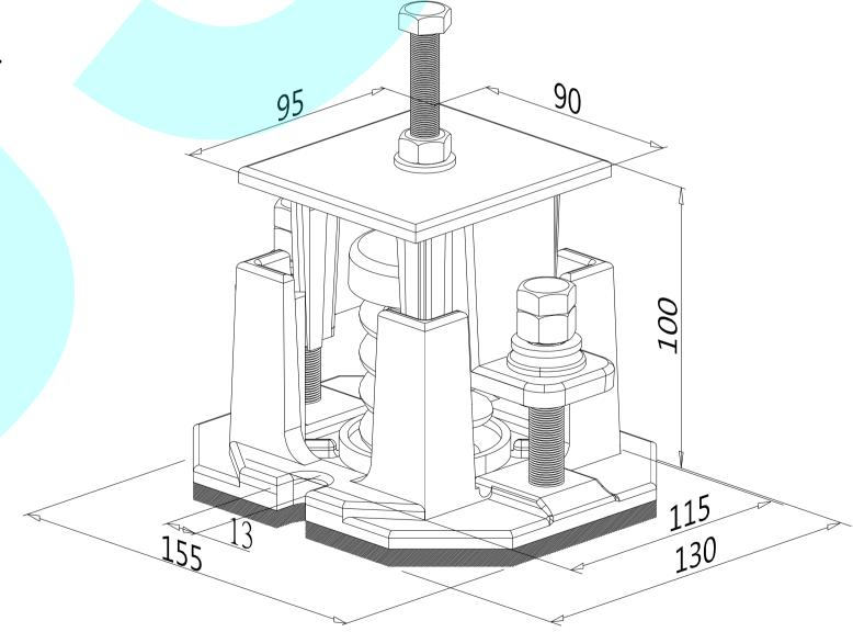
※ 保養點檢項目:每月觀察固定螺栓&基礎螺栓保持鎖固、保持避震器安裝狀態&彈簧下壓撓度正常。
