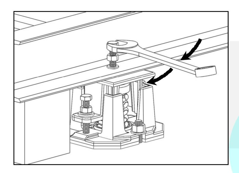
圖4)使用公制口徑17mm板手以順時針方向調整 螺栓,使彈簧下壓。
