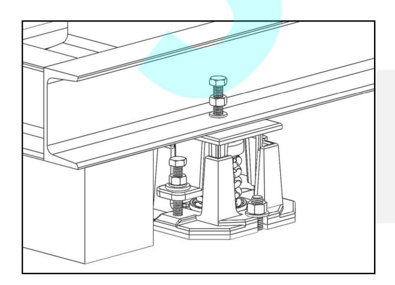
圖3)以M10固定螺栓將避震器與設備固定,但不鎖緊。
