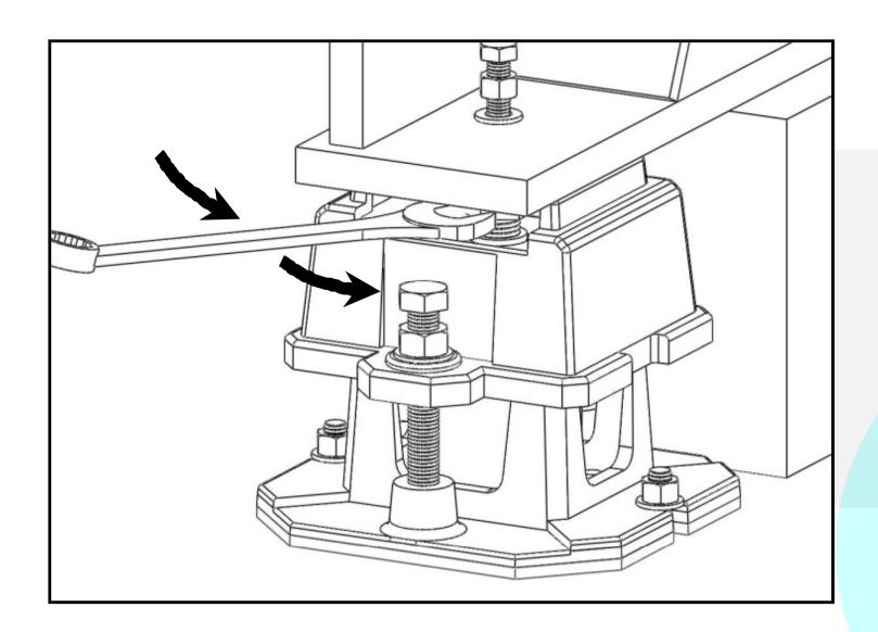
圖4)使用開口扳手以逆時針方向調整螺栓,緊 使彈簧受力下壓。
