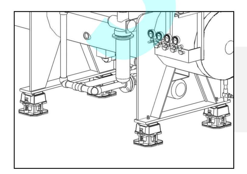
圖6)將固定螺栓與設備完全鎖緊後,即完成避 震器安裝調整。
