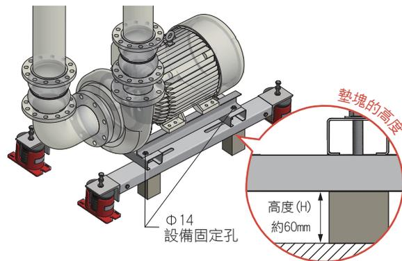
③ 將C型鋼依指示方向旋轉，並重新鎖固螺帽x4。
