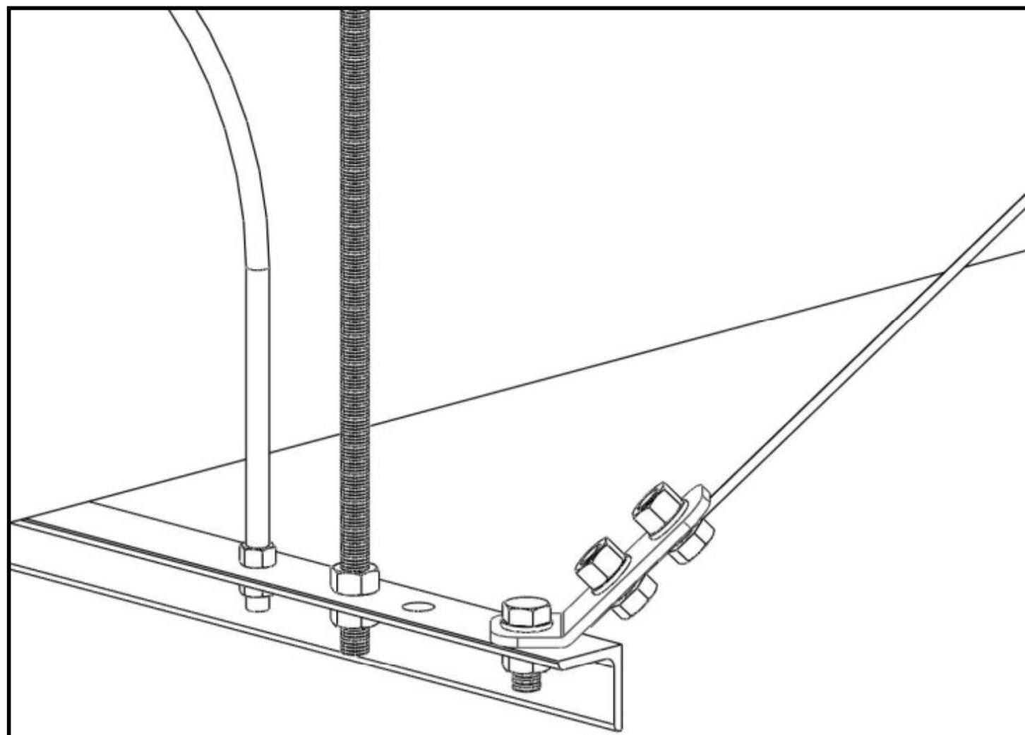
圖1) 以固定螺栓將震盪彎板與設備固定，但不鎖緊。
