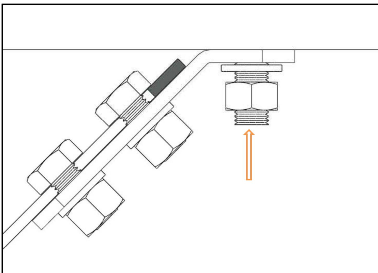
圖4) 調整至所需的安裝角度，將另一端彎板鎖固在安裝位置的基礎螺栓。
