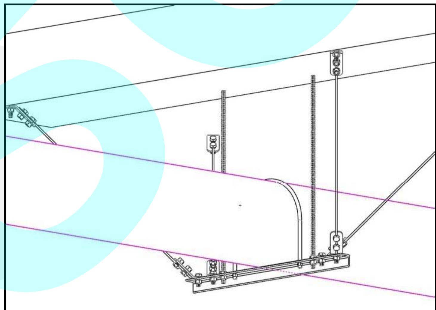
圖5) 確認安裝角度後鎖固設備端的擊震彎板，並檢視各螺栓是否完全鎖固。
