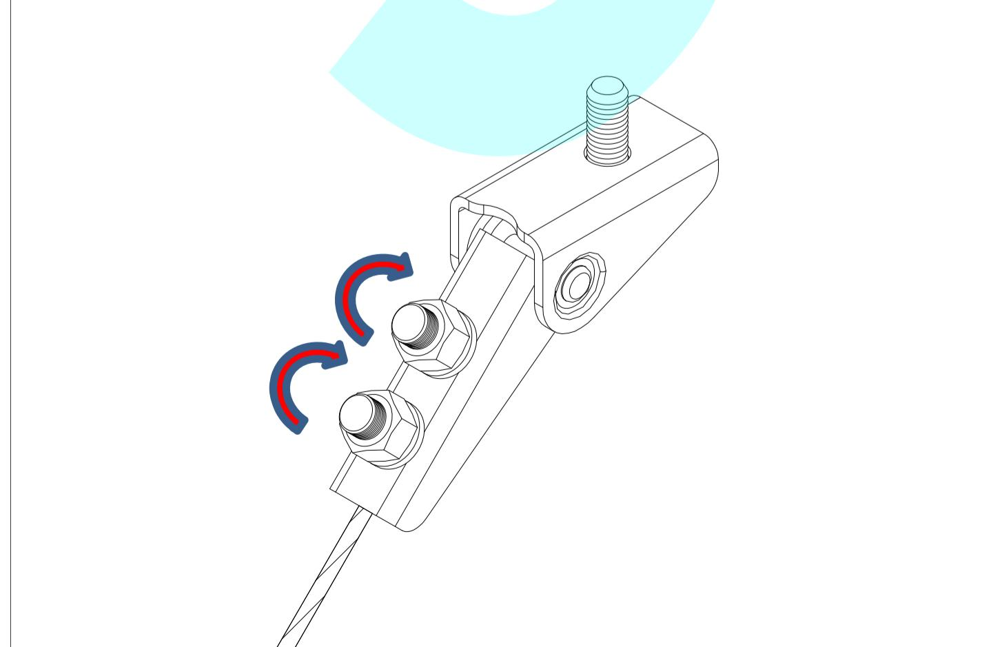
圖3) 以扳手完全鎖固穿孔螺栓，並使用扭力扳手檢查其鎖固扭力值。
