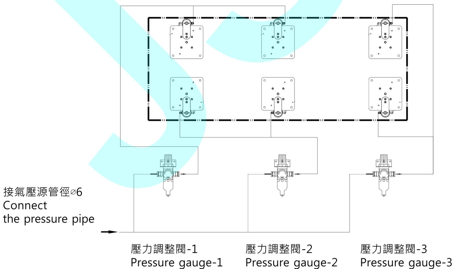
避震器荷重相同狀態下,可只使用1組壓力調整閥
