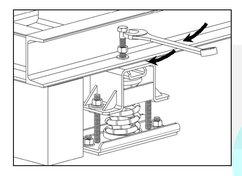
圖4) 使用公制口徑19mm板手以順時針方向調整螺栓,使彈簧下壓。
