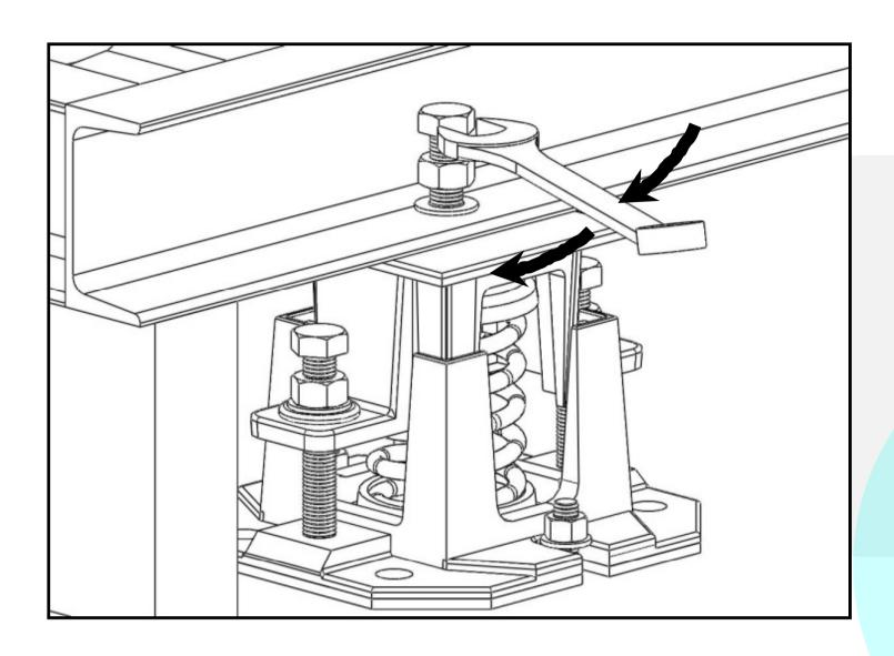
圖4)使用公制口徑24mm板手以順時針方向調整 螺栓,使彈簧下壓。
