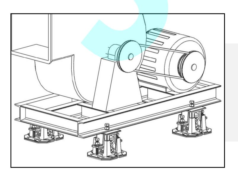
圖6)將M16螺栓與設備完全鎖緊後,即完成避 震器安裝調整。
