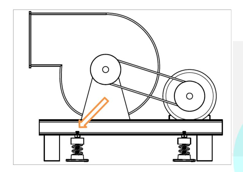
圖4) M12固定螺栓將避震器與基座固定,但不鎖緊。
