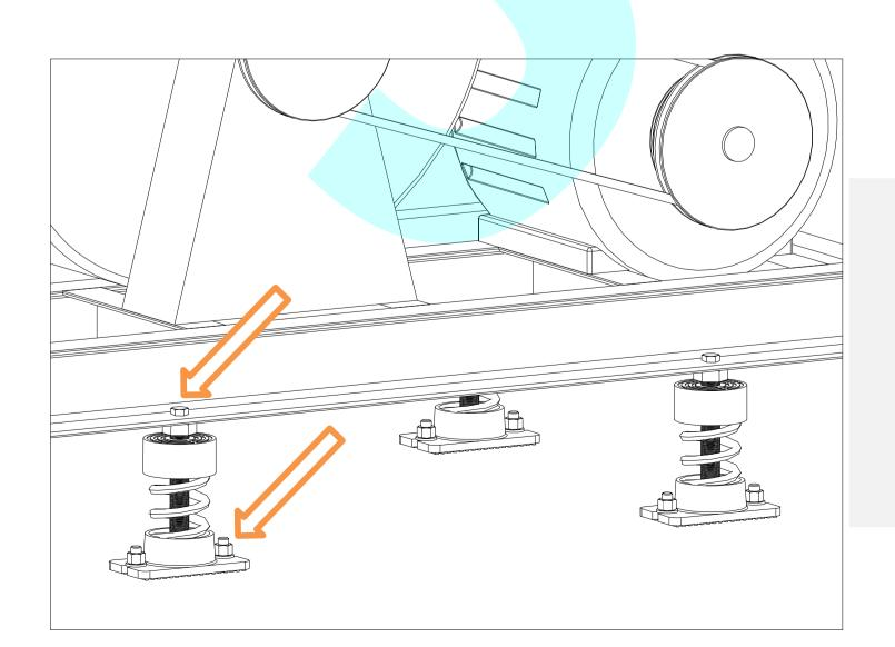
圖6) 將固定螺栓與設備完全鎖緊後,即完成避 震器安裝調整。
