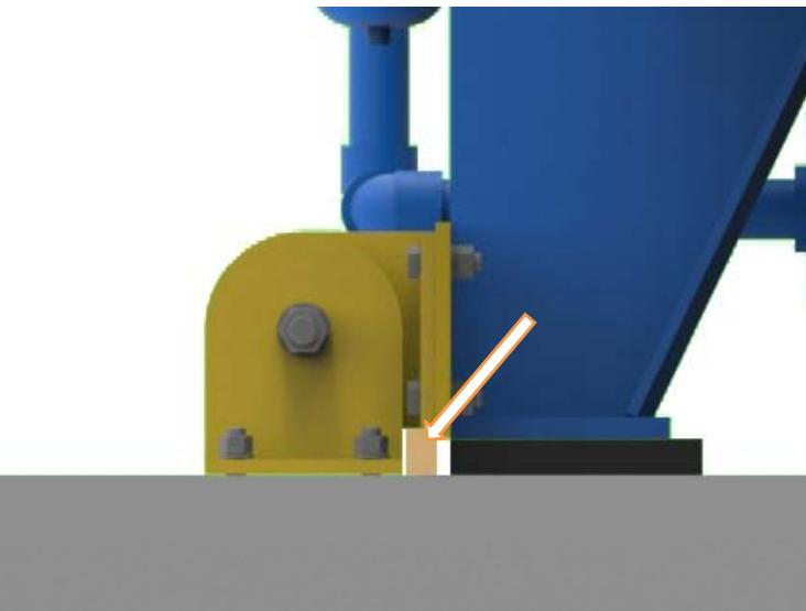
圖4) 安裝時須注意使鐵座保持90度(可用壓塊固定位置)。
