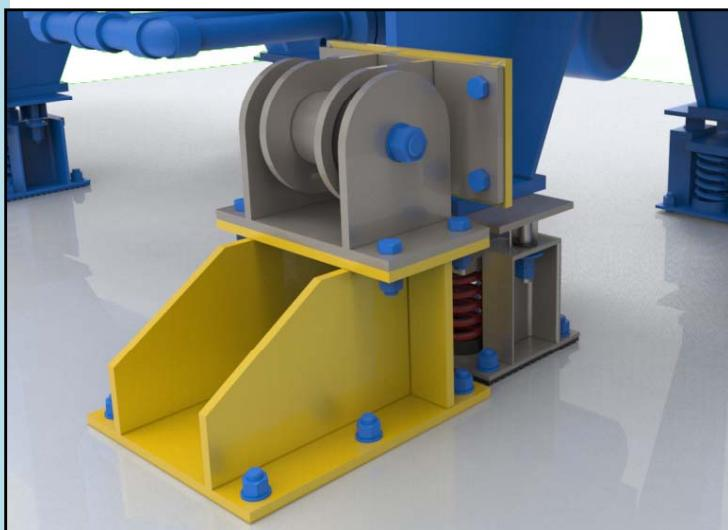
圖6) 若因設備安裝避震器而使震擊裝置高度不足時，須另安裝固定鐵座。
