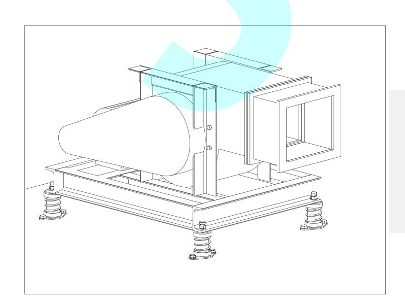
圖6) 將固定螺栓與設備完全鎖緊後,即完成避 震器安裝。
