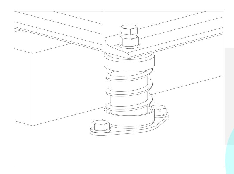
圖4) 利用M10固定螺栓將設備與避震器略為鎖固。
