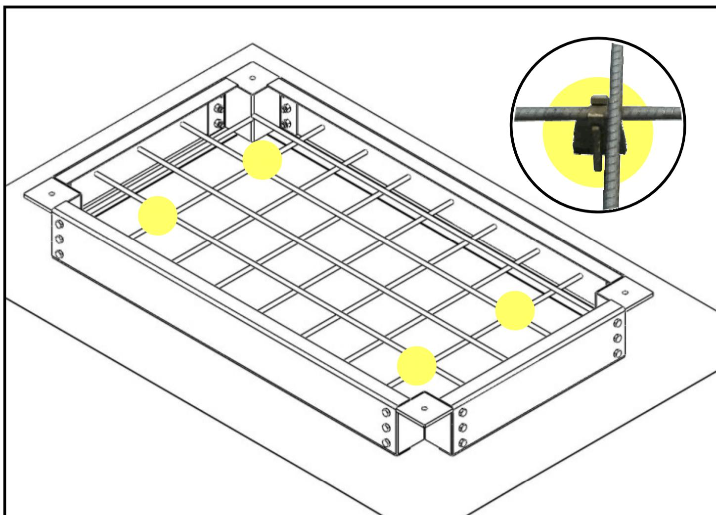
圖1) 將PE布或紙板鋪放於基座下方。將灌漿用塑膠墊塊放置黃色記號處。
