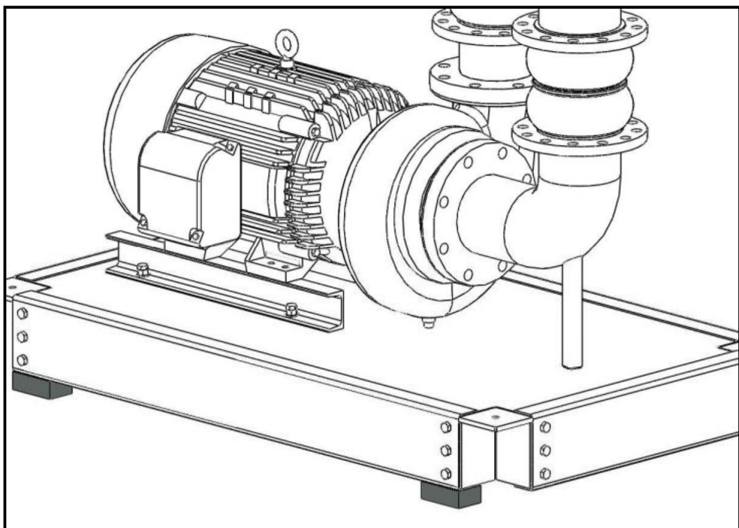
圖4) 將設備安裝固定於基座上，並完成設備的配管工程。
